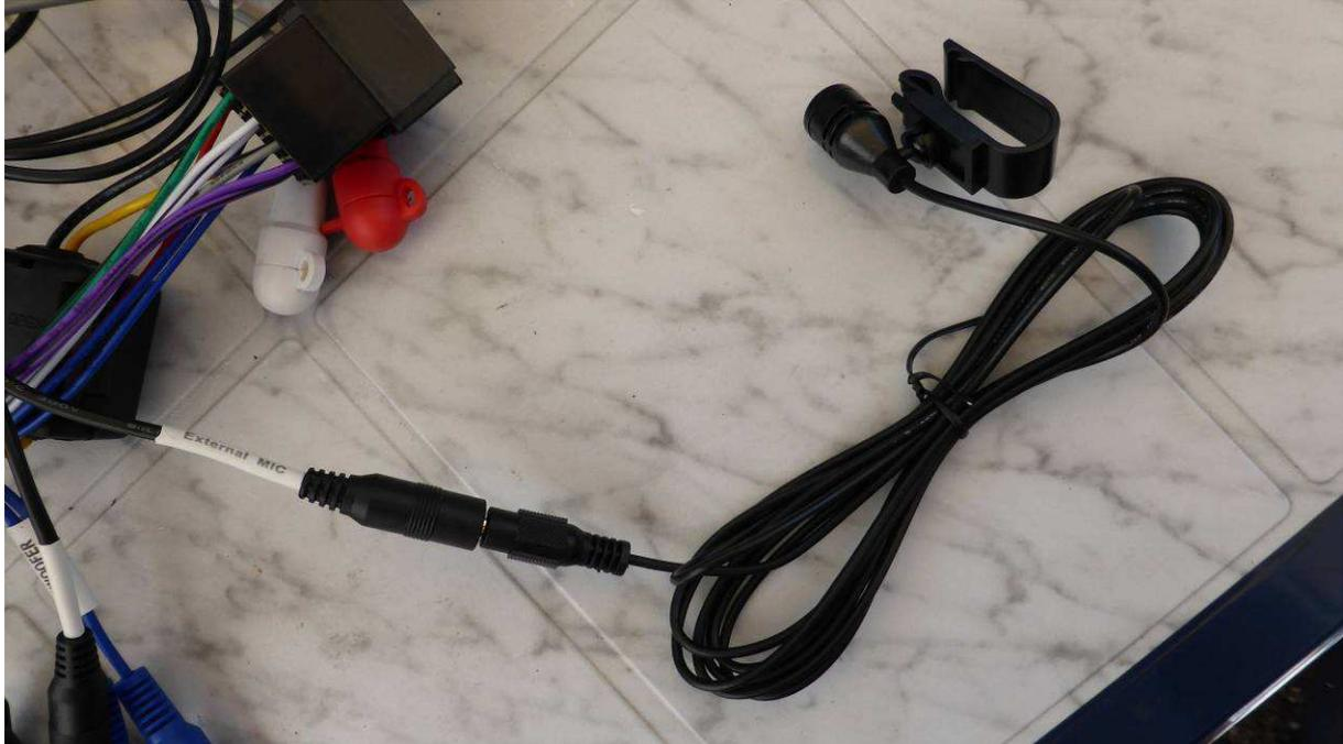
Das Mikrofon lässt sich im Fahrzeug mit dem beiliegenden Clip perfekt am Halter des Innenspiegels befestigen und das Kabel unter der Windschutzscheibendichtung unsichtbar verlegen.
