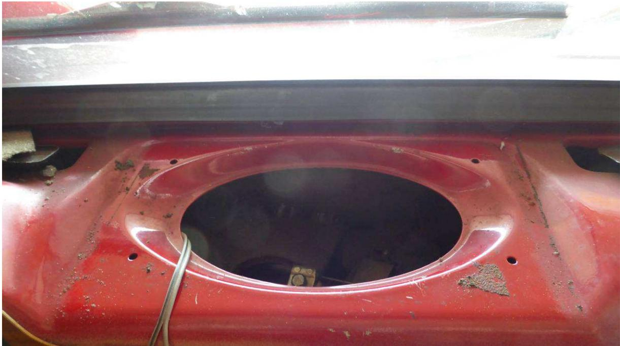
Die Befestigungslöcher des Lautsprechers stimmen exakt mit den originalen Befestigungsbohrungen in der Karosserie überein. Einfach mit den beiliegenden Schrauben und Blechmuttern befestigen:
