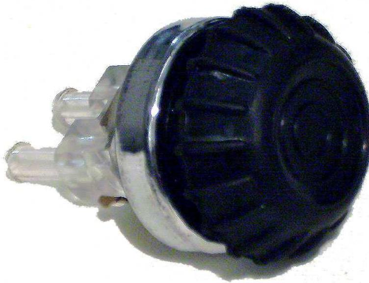
Wer kennt es nicht: Das Gummi der alten Pumpe ist morsch und die Scheibenwaschanlage, sowie der Scheibenwischerschalter lassen sich nicht mehr richtig bedienen. Wasser tritt aus den rissigen Stellen aus und „reinigt“ alles andere als die Windschutzscheibe. Eine Umrüstung auf die elektrische Pumpe des Nachfolgemodells ist aufwändig, teuer und nicht originalgetreu, da ein Leitungssatz, Relais, elektrische Pumpe, sowie ein anderer Wassertank und Blinkerschalter benötigt werden.
