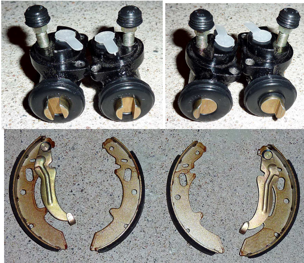
Die Abbildungen zeigen Radbremszylinder und Bremsbacken für Fahrzeuge ab Bj. 1973!
